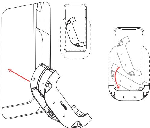
Bloccando stabilmente l'assemblato sulla parte inferiore della fresa, fissarlo con quattro delle viti contenute nel kit.
