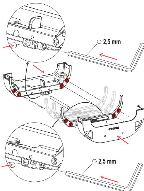
Ruotare l'assemblato così ottenuto ed infilarlo all'interno della fresa avendo cura di adagiarlo correttamente sulla parte inferiore della fresa.
