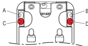
Se necessario, effettuare la regolazione azionando l'apposita vite con una chiave a brugola da 2,5 mm (la regolazione di ogni base maniglia avviene accedendovi dal lato opposto).
