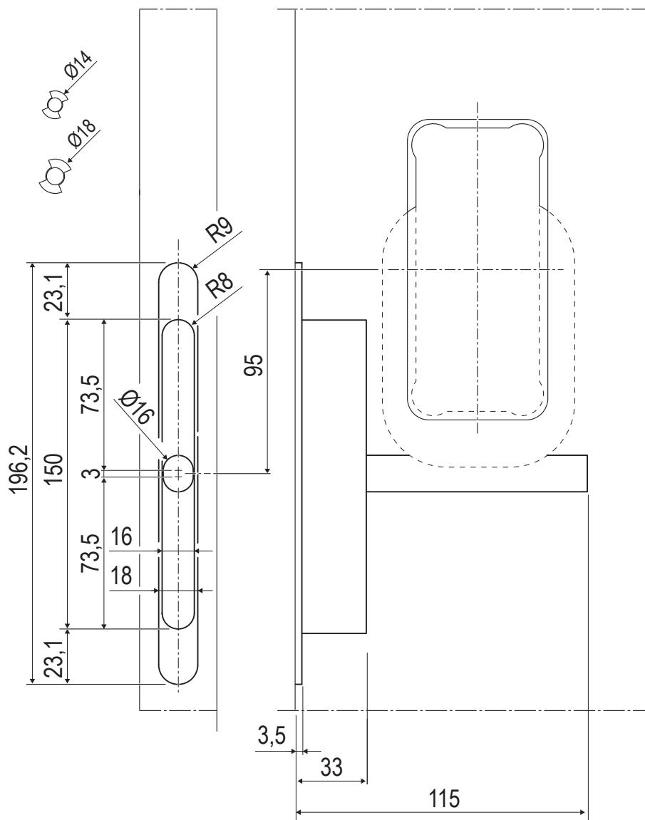
Installare la serratura scelta fissandola con le apposite viti.
