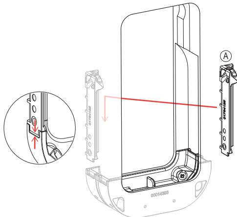
Fissare la presa con l'apposita vite, fornita nel kit.
