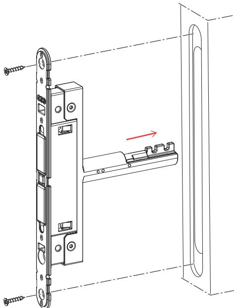
Scegliere le prese adatte alla tipologia di apertura che si vuole ottenere (attiva-passiva o passiva-passiva).
