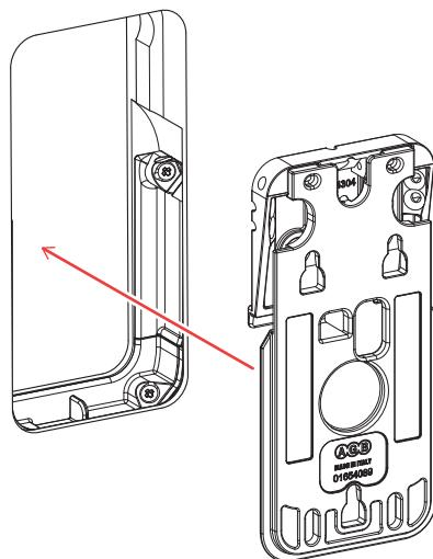
Fissare la base maniglia bloccandola con la vite centrale. Completare il fissaggio bloccando definitivamente la base maniglia con altre due viti poste in posizione A e B.
