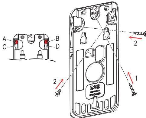
Seguire la medesima procedura per fissare la seconda base maniglia; in questo caso, usare i fori vite (C e D).
