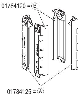
Inserire il componente (A) facendolo aderire alla fresa ed accoppiandolo correttamente alla presa inferiore.
