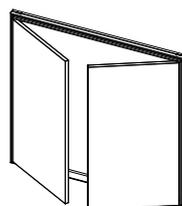
**ANTA DOPPIA** - Passaggio utile tra cerniere e serratura circa 150 mm in meno rispetto alla luce di passaggio
