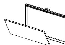
**ANTA A RIBALTA** - Passaggio utile tra cerniere e serratura circa 100 mm in meno rispetto alla luce di passaggio
